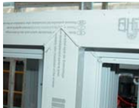
Mittelpfosten und Kämpfer werden bei Illerplastic standardmäßig verschweißt
